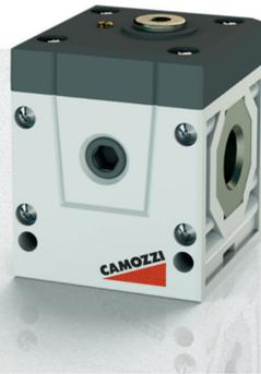
Клапан мягкого пуска **Серии MD** позволяет постепенно увеличивать давление в пневматических системах в момент первого запуска приводов после сброса давления из магистрали. Максимальная скорость потока достигается, когда давление на выходе составляет около 50% от давления на входе. Время нарастания давления регулируется с помощью регулирующего винта.
